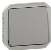
Interrupteur ou va-et-vient 10AX - Connexion rapide sans outil avec repérage couleur Produit à compléter soit avec un boîtier saillie, soit avec un support encastré IP55 : protégé contre les poussières et les projections d'eau à la lance de toutes directions IK08 : résistance à un choc de 5 joules
