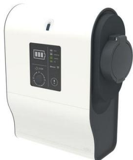
Borne monphasé plastique avec lecteur RFID Green'up Premium pour la recharge de véhicule électrique avec communication sans fils locale par Bluetooth : configuration et pilotage de la borne par smartphone, tablette via l'App, EV CHARGE light
