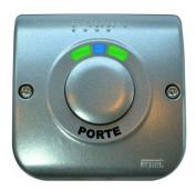
Information sonore par buzzer et lumineuse par voyant d?ouverture de porte. Gros bouton Ø 35 mm. Eclairage bleu de localisation. Buzzer réglable coupé/moyen/fort. Extinction en cas de porte bloquée ouverte. 1 contact NO et 1 contact NF indépendants. Câblage: prévoir un câble de 3 paires. Livré avec 2 vis inviolables de fermeture et un outil Torx de sécurité. Marquage en braille et gravure du mot ?porte?.
