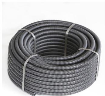
Conduit isolant et cintrable transversalement, équipé d'un tire-fil. Élastique et non propagateur de la flamme. Pose en apparent ou encastrée. Adapté pour le béton. Résistance à l'écrasement : 750N. Livré sous film anti UV.
