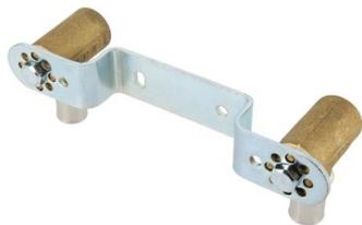
Coude multicouche applique à sertir femelle à visser avec support mural. Solution permettant une fixation murale pour création d'un double point de puisage. Obligatoirement associé aux tubes multicouches FLUXO. Profil de sertissage : TH. Qualité du laiton : Européen. Double joint torique : EPDM Perox. Douilles de sertissage : Inox. Design : Hexagonal. Taraudage : 1/2".
