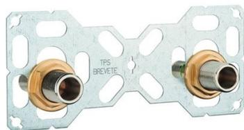
Raccord droit À sertir. Diamètre : Ø 16 mm Le raccord restent visitables après la pose du revêtement. Un système qui s'adapte à l'épaisseur de votre cloison. Entraxe de 150 mm. Composé de 3 encoches pour s'adapter à l'épaisseur de votre cloison. Raccord droit à sertir. Sortie M3/4 pour raccorder directement la robinetterie. Pour accéder au raccord, il suffit d'enlever le contre écrou.
