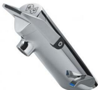
Pour lavabo permet le déclenchement de l'eau de manière souple par un simple appui, vers le haut ou vers le bas, sur la manette. L'eau s'arrête automatiquement après une simple temporisation réglée en usine (7 ou 15 sec) ou double temporisation 7 et 11 sec. La sélection de la température se fait grâce à une manette latérale.
