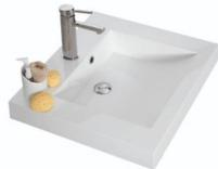
1 cuve centrée - P540. Longueur : 602 mm. Profondeur : 540 mm. Épaisseur : 80 mm. Dimensions de la cuve : Largeur : 430 mm ; Hauteur : 120 mm ; Profondeur : 370 mm. Blanc. Prévoir une robinetterie à tirette déportée. Dans le cadre de la mise en oeuvre PMR, installation obligatoire avec paire de consoles et siphon extra-plat.
