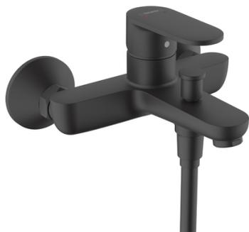
Vernis Blend Mitigeur bain/douche : 2 sorties = 2 fonctions. Longueur : 171 mm. Entraxe : 150 mm  $\pm$  12 mm. Type de jet du mitigeur : jet normal. Débit maximal sous 3 bars de pression : 22,5 l/min. Débit du bec déverseur sous 3 bars : 22,5 l/min. Débit de la douchette sous 3 bars : 15,7 l/min. Cartouche céramique. Limiteur de température réglable
