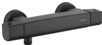
Mitigeur thermostatique douche. Limiteur de température anti-brûlure réglable : Bouton de sécurité avec blocage à 38°. Limiteur de débit : Economie d'eau grâce à la butée à 50% du débit. Ouverture avec butée sensitive à 50% du Débit. Bouton de sécurité 38°.
