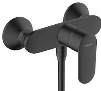
Mitigeur douche noir mat Vernis Blend. 1 sortie = 1 fonction. Type de raccordement: raccords S. Débit maximal sous 3 bars de pression: 28 l/min. Débit de la douchette sous 3 bars: 16 l/min. Cartouche céramique. Limiteur de température réglable. Clapet anti-retour Avec silencieux. Convient au chauffe-eau instantané. ACS 20 ACC NY 102 France, valide jusqu'au 23.06.2025
