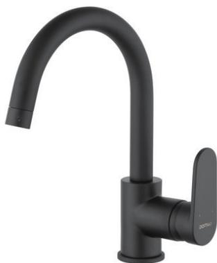
Mitigeur lavabo bec haut. Manette en métal. Cartouche diamètre 35 mm. Limiteur de débit : Economie d'eau grâce à la butée à 50% du débit. Entretien facile : mousseur anticalcaire. Hauteur totale : 266 mm, hauteur sous bec : 160 mm, longueur bec : 169 mm. ECAU : E0 C2 A2 U3
