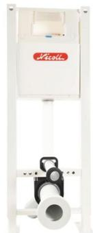
Bâti-support monobloc universel : fixation au sol et au mur ou au sol uniquement (autoportant). Réservoir de chasse équipé et réglé pour des volumes évacués de 3 et 6 litres (possibilité 2,5 et 4 litres). Pipe d'évacuation  $\varnothing$ 100 mm orientable (sortie droite ou coudée). Tube de rinçage, tube d'alimentation et manchon d'évacuation en PVC NF Me. Dispositif adapté aux installations pour les personnes à mobilité réduite (PMR). Plaque de commande vendue séparément.
