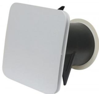
Complément du système de ventilation résidentielle. Elle sert à favoriser la diffusion ou l'extraction de l'air dans une pièce de l'habitat. Cet accessoire peut être installé directement sur le mur ou sur le plafond, à l'extrémité d'un conduit de ventilation. Elle est livrée avec un déflecteur optionnel pour canaliser la diffusion d'air dans le réseau d'insufflation. Cet accessoire est compatible avec tous les types de logement et les locaux tertiaires.
