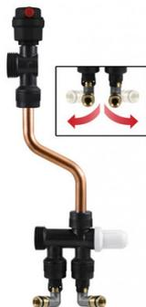
Groupe Bypass avec raccords coudés pivotants pour le remplissage de l'installation. Composé de (pièces en vrac) : Purgeur d'air. Groupe de réglage Bypass : Embouts et tuyau de raccordement. Raccord porte-manomètre G 1/8" (pour manomètre radial RBM  $\varnothing$  40 - échelle des valeurs 0  $\div$  10 bar - code 832.005)
