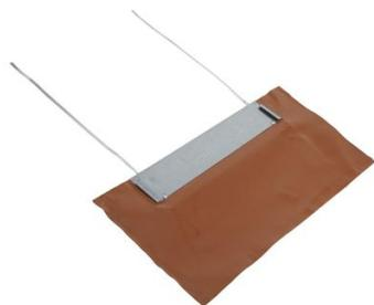
Le kit d'étanchéité associé aux embases universelles est un produit composite respectueux de l'environnement. Constitué d'une âme en aluminium extensible et d'un polymère avec une bande de butyle autocollante, ce produit s'adapte facilement aux profils des tuiles. Le kit d'étanchéité réf. KE est livré avec 2 bandes de mousse hydrofuge. Les plus : Légère et économique Sans gros ?uvre Entretien aisé Fabrication sur mesure
