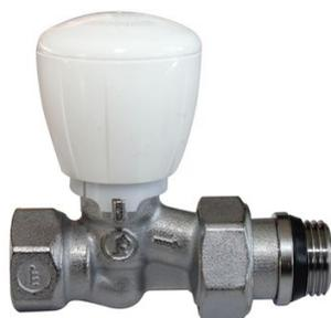
Série "FER". Douille avec joint auto-étanche en élastomère. Double réglage micrométrique. Température : 5-110 °C. Pression max de service : 16 bars. Composition : corps, écrou et douille en laiton, volant en ABS. Livré avec capuchon de protection.
