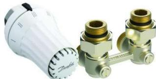
Kit 2 pièces: Tête thermostatique Danfoss RAE-K technologie liquide, pour corps M30x1,5 Répartiteur RLV-KS 1/2" équerre.
