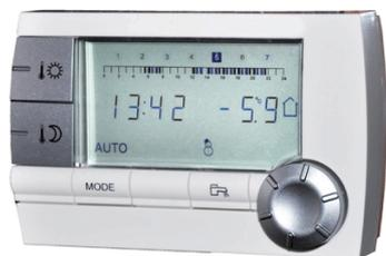
Module radio de commande à distance CDR D.ISYSTEM (Sans émetteur/récepteur radio).
