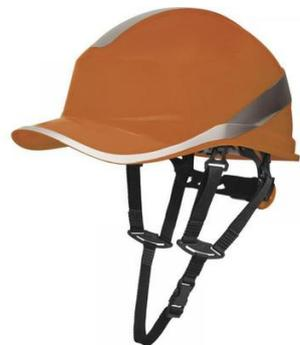
Casque de chantier en ABS avec design innovant. Testé en position "reverse". Coiffe Polyamide : 3 bandeaux textiles avec 8 points de fixation. Basane éponge. Système de serrage. Rotor : tour de tête de 53 à 63 cm. 2 positions possibles du tour de tête (haute/basse) pour un meilleur confort. Bande rétro-réfléchissante. Isolement électrique à 1 000 VAC / 1 500 VCC. Vendu avec jugulaire 4 points de fixation. Conforme la norme EN397 MM LD -30°C +50°C 440 VAC - EN50365 CLASSE 0.
