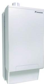
Combinaison d'une pompe à chaleur à haute efficacité et d'une chaudière gaz à condensation à rendement élevé. Unité intérieure murale compacte. Fonctionnement garanti par -25°C extérieur. Production ECS par micro-accumulation : classe 3 étoiles. Large plage de modulation : à partir de 1,8 kW. Pilotage à distance avec l'application Daikin Online Controller.
