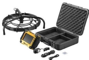
Inspection de canalisations Ø 50 - 150 mm, distance max. 30 m. Tête de caméra Ø 25 mm à photosensibilité élevée, souple et étanche avec émetteur. Taille caméra : ? 25 mm. Résolution caméra : 640 x 480 pixels. Sensibilité lumière : 0,1 Lux. Étanchéité caméra : IP 67.
