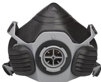
Demi-masque confort, tri-matière : corps du masque en thermoplastique élastomère (TPE) - Support pour ancrage des cartouches en polyéthylène HD (HDPE) - Carter de protection de la valve en polypropylène (PP). Lanières élastiques. Prévu pour 1 galette filtrante : M6000 P3, M6000 PREP3 ou M6000 A1 vendue séparément. Emballage boîte carton. Ancrage à baïonnette M6000. Compatible avec la gamme de cartouches M6000 (gaz et particules). Conforme à la norme EN140:1998
