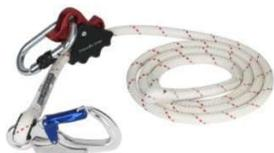
Les points fondamentaux de cet équipement : Utilisation facile et rapide, légèreté et fonctionnalité optimale. Drisse statique polyamide diamètre 12 mm de 2 mètres, boucles cousues. Cette longe de maintien au travail est équipée d'un tendeur de longe en alliage léger référence 371, d'un mousqueton référence 40 et d'un mousqueton en alliage léger à double sécurité référence 80.
