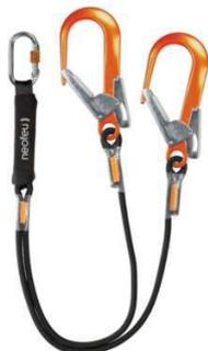
Absorbeur d'énergie avec longe drisse double (Y) intégrée. Un connecteur amovible est positionné côté absorbeur d'énergie et deux connecteurs amovibles ou inamovibles côté longe pour travaux en hauteur sur plan vertical ou horizontal avec risques de chute verticale par dessus une arête vive (Rayon : 0,5 mm) et avec espace disponible sous les pieds de l'utilisateur (voir tirant d'air).
