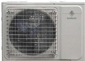
L'unité extérieure est équipée d'un compresseur Rotary DC Inverter, d'une vanne 4 voies pour l'inversion des modes chaud/froid, d'un ventilateur modulant.
