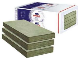
Le panneau roulé isolant thermo-acoustique Façade 35 R de Ursa, semi-rigide, est fabriqué à base de laine de verre, et est revêtu sur une face d'un voile de verre naturel renforcé. Ce rouleau de laine minérale est particulièrement destiné à l'ITE (isolation thermique par l'extérieur) des murs sous bardages ventilés perforés et murs rideaux dans les bâtiments non résidentiels (dont bâtiments industriels).
