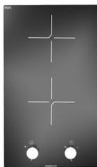
Plaque de cuisson vitrocéramique avec manettes : 1 zone Ø145/1500 Watts et 1 zone Ø180/1500 Watts. Dispose d'une sécurité enfant et détection de casserole. Finition plein verre noir avec sérigraphie.
