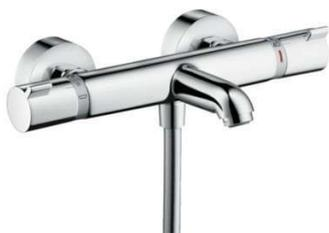
Thermostatique bain/douche G 1/2. Inverseur intégré dans la poignée. Verrouillage de sécurité à 40°. Limitation d'eau chaude pré réglable. Clapets antiretour. Raccords S avec amortisseur de bruit. Entraxe 150 +- 12 mm.
