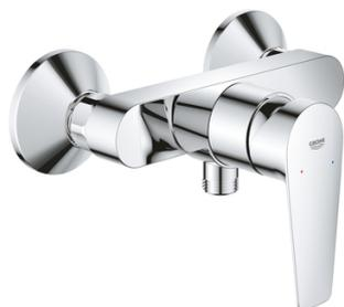
Montage mural apparent. Levier de commande métallique. GROHE Long-Life cartouche céramique 35 mm. Avec butée 1/2 débit. Avec limiteur de température. GROHE Long-Life Shine Chrome éclatant et durable. Clapet anti-retour intégré dans le départ douche 1/2". Raccords en S. Rosace métallique.
