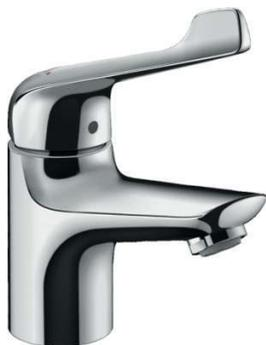
Comprend : mitigeur de lavabo, garniture de vidage. ComfortZone 70. Gros caractères pour plus de clarté. Avec poignée extra longue. Type de jet : jet normal. Débit maximal sous 3 bars de pression: 5 l/min. Cartouche céramique. Limiteur de température réglable. Convient au chauffe-eau instantané. Garniture de vidage 1 1/4". Matériau de la garniture de vidage : métallique. ACS 17 ACC LY 602, valide jusqu'au 10.10.2022
