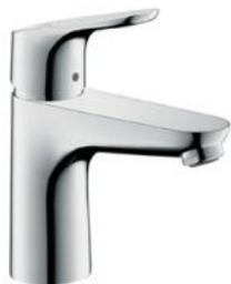
ComfortZone 100. Projection: 119 mm. Hauteur du bec: 94 mm. Type de jet: jet normal. Débit maximal à 3 bars: 5 l/min. Cartouche céramique. Limiteur de température réglable. Convient au chauffe-eau instantané. ACS 22 ACC LY 299, valide jusqu'au 07.06.2027.
