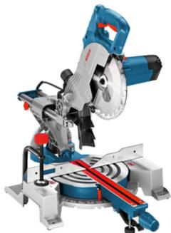
Modèle compact et léger pour les coupes standard. Seulement 13,5 kg pour une maniabilité parfaite. Capacité de coupe horizontale de 270 mm pour les applications standard. Capacité de coupe 0° 70 x 270 mm. Capacité de coupe onglet 45° 70 x 190 mm. Capacité de coupe inclinaison 45° 48 x 270 mm. Coupe d'onglet 47° G / 47° D. Réglage d'inclinaison 45° G / 0° D. Régime à vide 5.500 tr/min. Diamètre de la lame 216 mm. Ø alésage 30 mm.
