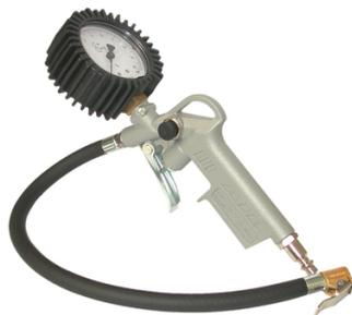
Modèle Universel, spécial VL. Pistolet de gonflage poinçonné et homologué CE. Poignée ergonomique en aluminium. Manomètre Ø 63 mm 0-10 bar - précision 0,1 bar. Flexible 35 cm -18/20 bar. Bouton de dégonflage.
