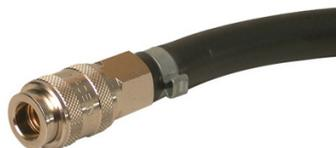
Tuyau professionnel avec raccords rapides gros débit. Les accessoires Lacmé sont munis d'embouts raccords rapides permettant un raccordement immédiat par enclenchement dans les coupleurs qui équipent tous les tuyaux. Lors du "dé-enclenchement", les coupleurs se ferment automatiquement, évitant ainsi de manoeuvrer les robinets sur lesquels sont branchés les tuyaux.
