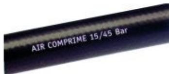
Tuyau caoutchouc avec renforcement en fibres textiles. Conception en SBR et NBR souples, avec renforcement en fibre polyester haute ténacité. Points forts : Utilisable par tous les temps, il est le tuyau idéal pour l'équipement des compresseurs de chantier. Applications : Equipement des compresseurs de chantier pour alimentation pneumatiques. Usage normal.
