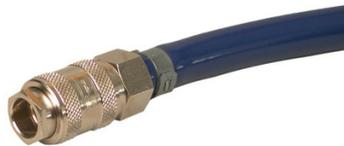
Tuyau Universel avec raccords rapides. Les accessoires Lacmé sont munis d'embouts raccords rapides permettant un raccordement immédiat par enclenchement dans les coupleurs qui équipent tous les tuyaux. Lors du "dé-enclenchement", les coupleurs se ferment automatiquement, évitant ainsi de manoeuvrer les robinets sur lesquels sont branchés les tuyaux.
