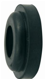
Joint pour raccord express en laiton. Eau et air comprimé. Entre-griffes : 41 mm. Joint nitrile. PMS 10 bar. Températures d'utilisation : de - 5 °C à + 60 °C.
