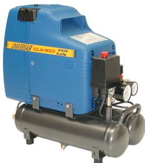
Compresseur professionnel portable, monophasé, groupe monobloc monocylindre sans huile entièrement protégé. Puissant 12,1 m<sup>3</sup>/h, sur cuves 2 x 2,6 litres - 10 bar maxi. Il bénéficie également de la technologie sans huile (SH). L'air comprimé obtenu est plus propre et son entretien est plus simple. Il est très compact et léger (18,4 kg), il est facile à porter et transporter. Il est idéal pour l'alimentation de petits cloueurs et de petits outils.
