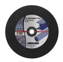
Le disque abrasif à moyeu plat de SIDAMO A 36 RBF 131 est parfaitement adapté pour la coupe de métaux ferreux sur tronçonneuse de chantier à faible puissance. Conçu pour une puissance de 3 kW maximum.Très bonne vitesse de coupe et longévité. Renforcement 2 armatures extérieures en fibre de verre tissée et résinée sur toute la surface du disque.
