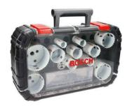
Ce coffret de scie cloche professionnel est composé de 14 pièces et convient pour la découpe du bois, du métal et du PVC. 8 scies-trépans, diamètres 20mm / 22mm / 25mm / 32mm / 35mm / 40mm / 44mm / 51mm / 60mm / 68mm / 76mm. 1 adaptateur Power Change Hex. adaptateur Power Change SDS + Plus. 1 foret de centrage HSS-G.
