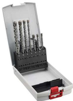
2 taillants, avec technologie de brasage et de trempe optimisée en fonction du diamètre pour améliorer la robustesse du foret et réduire les vibrations pendant le perçage. Dimensions : 5, 6, 8x115 et 6, 8, 10, 12 x165 mm. En coffret métallique incassable.
