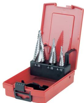
Sens de coupe à droite. Pour épaisseur jusqu'à 3 mm. Diamètres : 4 - 12 mm / 4 - 20 mm / 4 - 30 mm.
