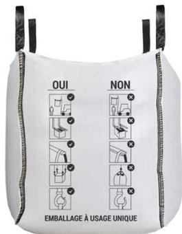
Big bag 1m3, ouverture totale fond plat, charge maximale utile 1500 kg, non réutilisable, fourreaux de protection sur les 4 anses et pictogrammes de manutention imprimés sur 1 face du sac. Coefficient de sécurité : 5/1 (usage unique). Toile lourde en polypropylène résistante aux UV. Fond plat.
