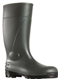
Tige PVC haute résistance. Protection des malléoles et du talon. Semelle PVC/Nitrile, forte adhérence sur sols gras et meubles. Semelle résistante à l'abrasion et antistatique. Profil réhaussé pour une meilleure résistance aux chocs frontaux. Crampons autonettoyants. Embout 200J.
