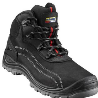
Botte de sécurité version large avec protection contre la pénétration grâce à son embout en aluminium. Bonne respirabilité avec sa doublure mesh. La botte est également disponible en version avec embout en acier. Sa partie supérieure en cuir nubuck et semelle extérieure en TPU permet une bonne adhérence et est résistante à l'eau et oléofuge. La botte est stable et absorbe les chocs
