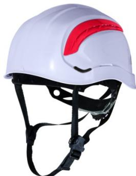
Casque de chantier ventilé, en ABS. Style casque de montagne : sans visière pour une meilleure vision verticale. Très peu d'encombrement. Léger. Coiffe polyamide : 3 bandeaux textiles avec 8 points de fixation. Basane thermoformée. Système de serrage ROTOR ajustable : tour de tête de 53 à 63 cm. Vendu avec jugulaire 3 points de fixation. Système de serrage ergonomique One-D Rotor, ajustement d'une seule main. Basane thermoformée remplaçable.
