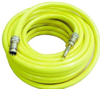
Le kit est composé : d'un tuyau, 1 nez de robinet 20x27 mm en laiton, 2 raccords automatiques en laiton et une lance en laiton. Tuyau 5 couches de qualité standard. Tube intérieur lisse en PVC, couche intermédiaire en PVC 100% recyclé. Armature en fibres polyester haute ténacité. Revêtement en PVC souple anti-UV. Renforcement spécialATH supprimant le phénomène de vrillage sous pression.
