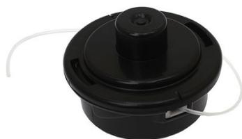
Tête pour rotofil MS335-4U, sortie de fil semi-automatique. Le fil de coupe sort lorsque vous frappez la tête à fil sur le sol. Ainsi, le fil est libéré et la force centrifuge adapte sa longueur selon le besoin rencontré.
