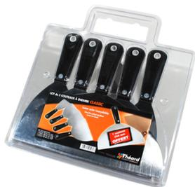
Lame de haute qualité en acier bleui souple et indéformable. Épaisseur obtenue par laminage. Dureté 157 daN/mm<sup>2</sup>. Patte : diamètre important 10 mm pour une résistance supérieure. Soudure 2 points de qualité, avec centrage garanti, meulé. Manche en bois dur (hêtre). Deuxième virole pour ajuster en frappant. Finition nickelée. Comprend : 1 couteau 75 mm, 1 couteau 100 mm, 1 couteau 125 mm, 1 couteau 150 mm, 1 couteau 250 mm.
